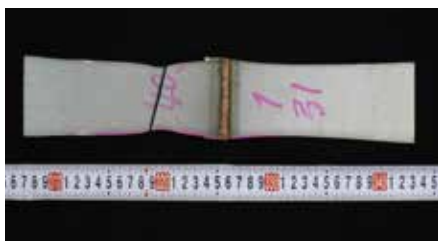
引張試験片の外観
